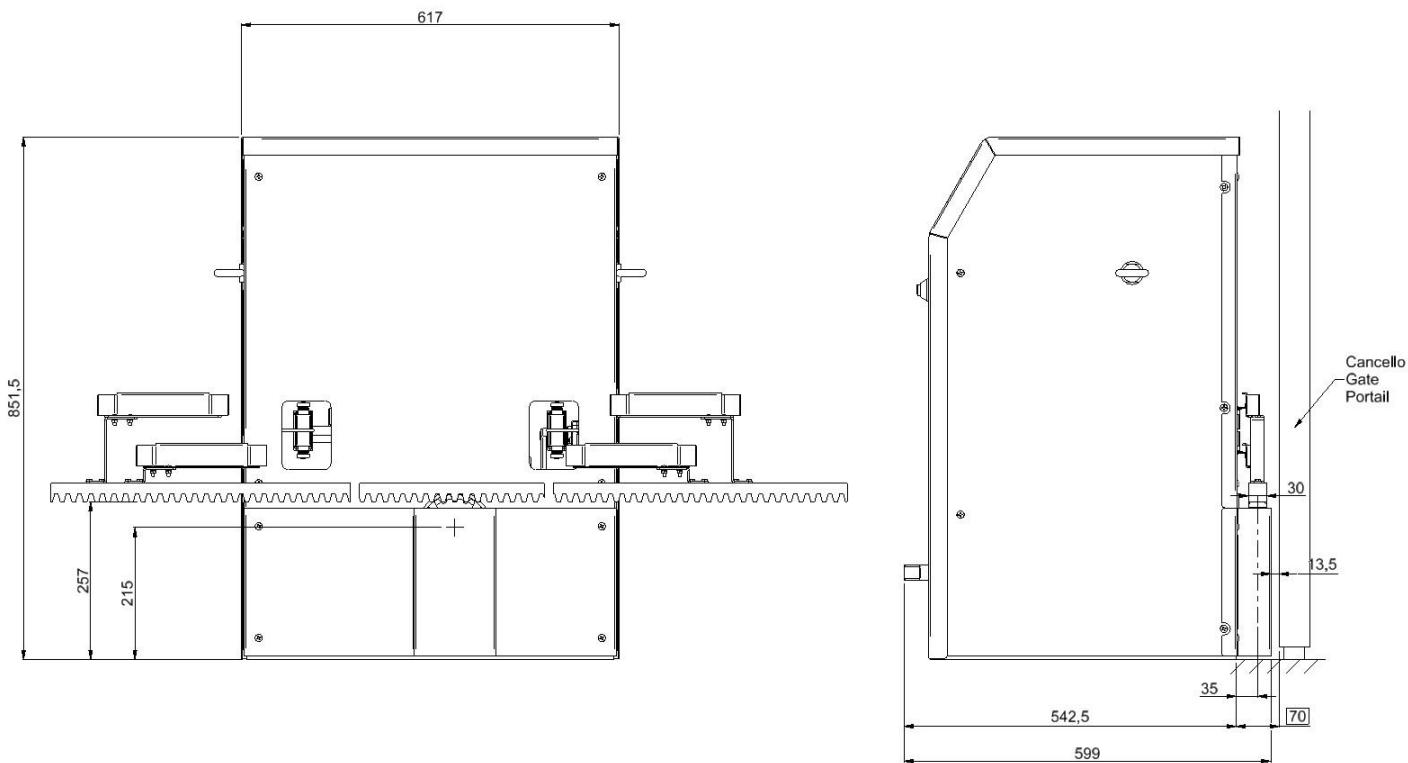
L'operatore, destinato ad impianti di dimensioni e pesi molto elevati, è sprovvisto di limitatore di coppia. A cura dell'installatore dotare l'impianto dei dispositivi antinfortunistici e delle protezioni richieste dalle norme vigenti.
